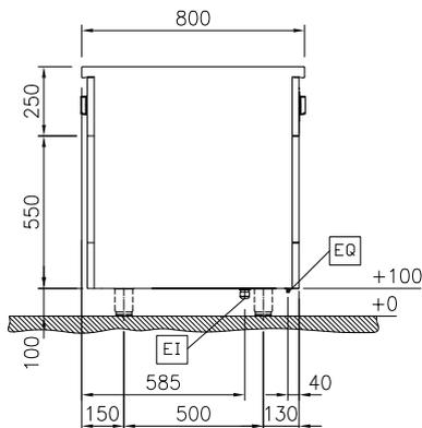
EI = Conexión eléctrica (energía)
